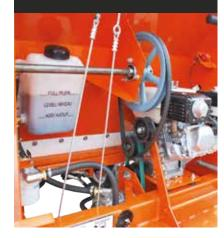
Die Antriebsräder werden von zwei Hydraulikmotoren, die von einer Hydrostatikpumpe versorgt werden, direkt angetrieben. Dadurch entfällt die teure und komplizierte Wartung eines Differential- oder Schaltgetriebes.
