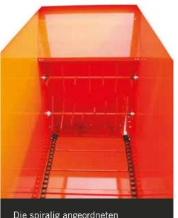
Die spiralig angeordneten Schlägel regulieren den Fluss des Futters und schalten die Gefahr der Brückenbildung aus, die Beschaffenheit der Silage ist dabei gleichgültig. Diese Antriebstechnik und die Verwendung hochwertiger mechanischer Komponenten sorgen dafür, dass der Valmetal Hydraucart eine äußerst effektive Maschine ist.
